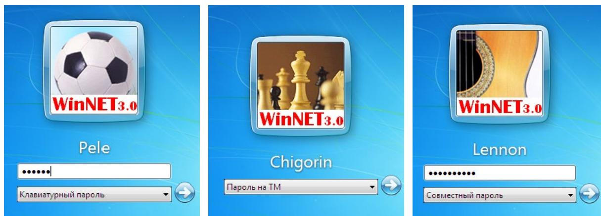
Рисунок 7. Возможные состояния диалога входа на рабочую станцию в зависимости от выбранного способа формирования пароля. Пользователь Pele использует обычный клавиатурный пароль (он выбрал "Клавиатурный пароль"), пользователь Chigorin использует устройство считывания ТМ (он выбрал "Пароль на ТМ"), а пользователь Lennon – комбинированный метод, при котором одна часть пароля хранится на ТМ, а вторая вводится с клавиатуры – он выбрал "Совместный пароль".
